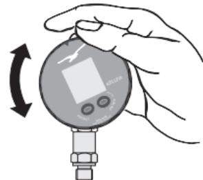
tourner par rapport au capteur. Orienter la face avant et resserrer le contre écrou.
