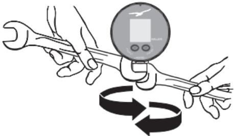
Aufnehmer verdrehen. Ausrichten der Frontseite in die optimale Richtung und Anziehen der Gegenmutter.
