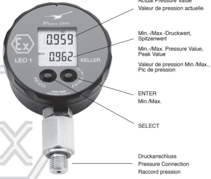
Eigensicheres digitales Manometer mit Spitzendruckwert-Erfassung und Min.-/Max.-Anzeige.
